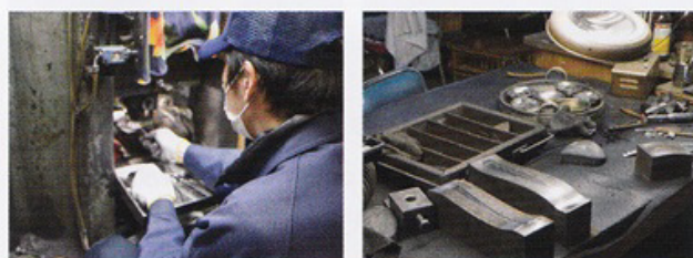
図7 プレス工程(左)と型修正作業台(右) 転写される製品のわずかな表情の変化を読み取り、金型への修正を加えています
