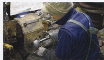
図8 仕上げ研磨工程 回転砥石へ絶妙な力加減・角度で製品を当て、美しい表面に仕上げていきます
